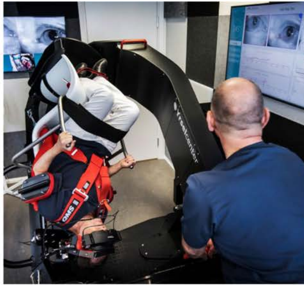
TRV-stolen används för diagnostik och accelerationsbehandling av kristallsjuka. Via glasögonen filmas ögonrörelserna. Foto: Linus Sundahl-Djerf
